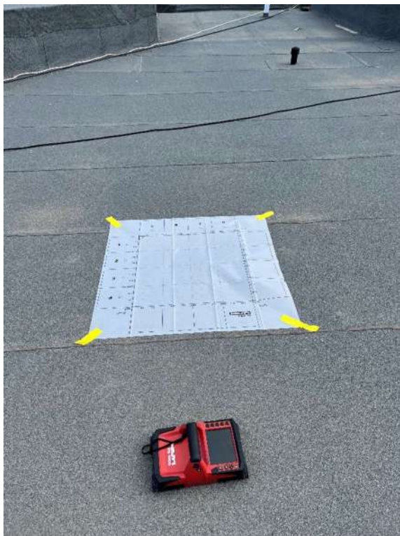
Μέτρηση κανάβου πλάκας με το Hilti X-scan PS1000.
