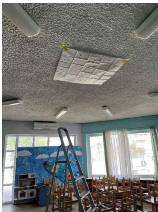
Μέτρηση Πλάκας με το Hilti Ferroskan PS300.
