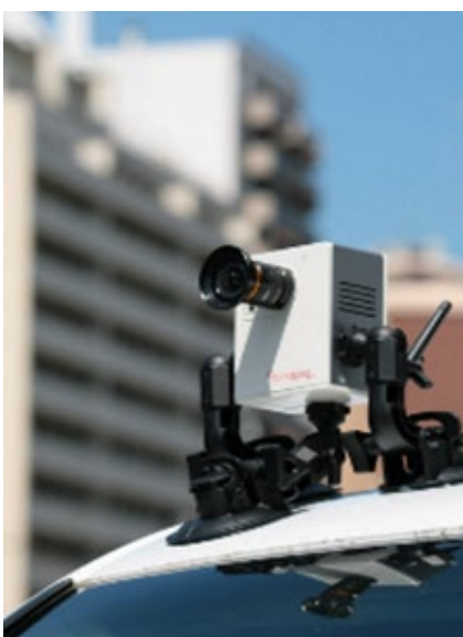
Εικόνα 2 Κάμερα με GNSS και INS καταγραφής
