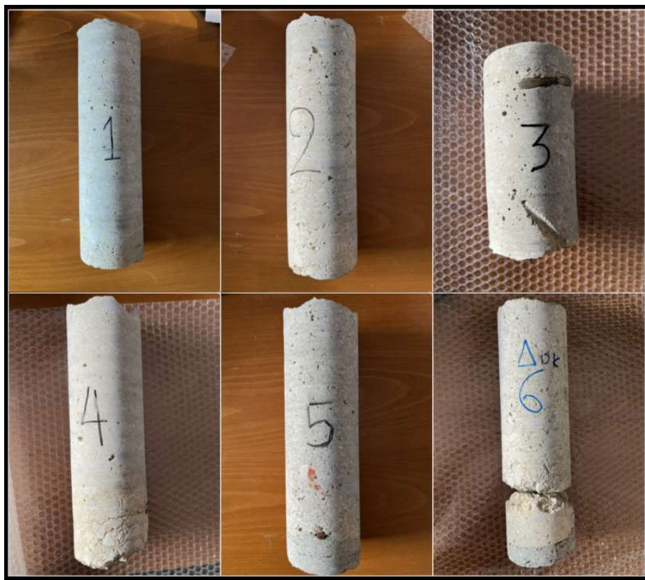
Φωτογραφική αποτύπωση των πυρήνων σκυροδέματος.
